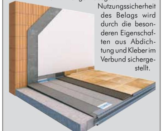
Nutzungssicherheit des Belags wird durch die besonderen Eigenschaften aus Abdichtung und Kleber im Verbund sichergestellt.
