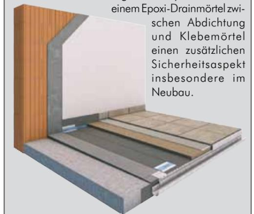
einem Epoxi-Drainmörtel zwischen Abdichtung und Klebemörtel einen zusätzlichen Sicherheitsaspekt insbesondere im Neubau.
