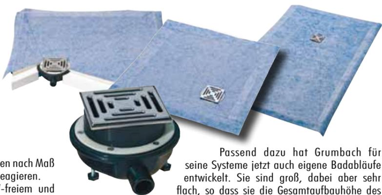
Passend dazu hat Grumbach für seine Systeme jetzt auch eigene Badabläufe entwickelt. Sie sind groß, dabei aber sehr flach, so dass sie die Gesamtaufbauhöhe des Duschbodens auf bis zu 75 mm reduzieren können. Eine waagerechte (DN40) und eine senkrechte (DN50) Ausführung gehören ebenso zum Programm wie Geruchsverschlusssteile aus flexiblem EPDM, die leicht zu entnehmen und zu reinigen sind. Die Sperrwasserhöhe beträgt 40 mm.
