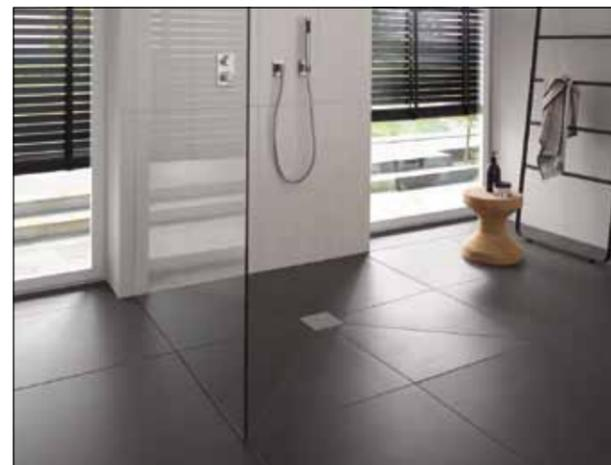
Zentrale Punktabläufe in Verbindung mit großformatigen Fliesen erfordern wegen des Gefälles Fugenschritte. Geschickt geplant, kann auch das dekorativ aussehen.
