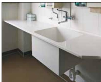
den Boden tropfendes Wasser. Hergestellt wird das Becken aus dem Mineralwerkstoff „Miranit“. Das bruchfeste Material umschließt eine glatte, porenfreie Außenhaut. Diese Gelcoatschicht ist pflegeleicht und widerstandsfähig. Die alpinweiße Oberfläche verfügt über eine hohe Schlag- und Abriebfestigkeit sowie gute Laugen- und Säurebeständigkeit und ist temperaturbeständig bis 80°C.
