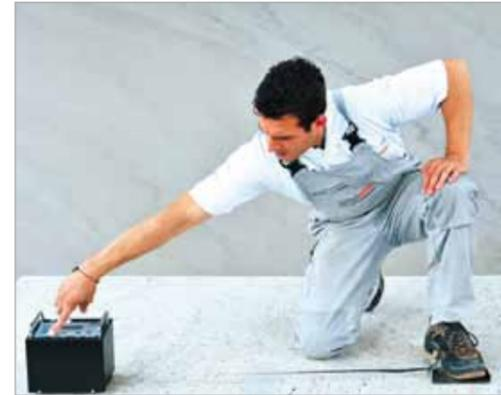
Zur Ermittlung des Gleitwiderstandes am Boden werden vor Ort mobile Messgeräte eingesetzt. So lässt sich der Zustand der Oberfläche effektiv beurteilen als Voraussetzung für die richtigen Maßnahmen.
