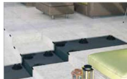
beschäftigt hat, ist Proline Systems. Es hat das Verlegesystem „Prostil“ als Ergänzung zu bekannten Verlegemethoden ins Sortiment aufgenommen und auf der BAU in München vorgestellt. Bei diesem System werden die Belagsmaterialien lose auf die Stelz- und Plattenlager aufgelegt. Dank integrierter Fugenstege ist für gleichbleibende Fugenbreiten gesorgt, durch die Niederschlagswasser in den Untergrund abfließen kann.
