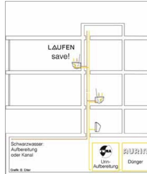
Der Querschnitt zeigt, wie der Urin mittels des Trenn-WCs save! separiert werden und schon im Gebäude nach dem Vuna-Verfahren zu Dünger aufbereitet werden kann.
