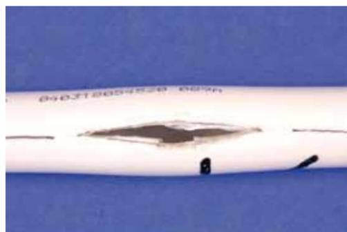
Dieses Mehrschichtverbundrohr platzte aufgrund einer fehlerhaften Produktion.
