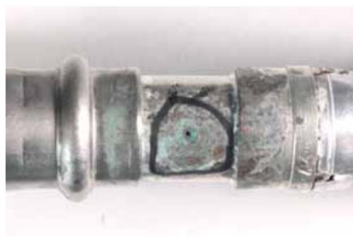
Ungünstige Wasserbedingungen führten zu einer Lochkorrosion in dem Übergangsstück.
