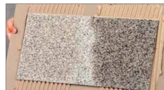
Bild 3: Kritische Naturwerksteine durchfeuchten mit herkömmlichen Verlegemörtel (rechts). Dank der kristallinen Wasserbindung können mit PCI Carrament grau Platten verfärbungsfrei verlegt werden (links).
