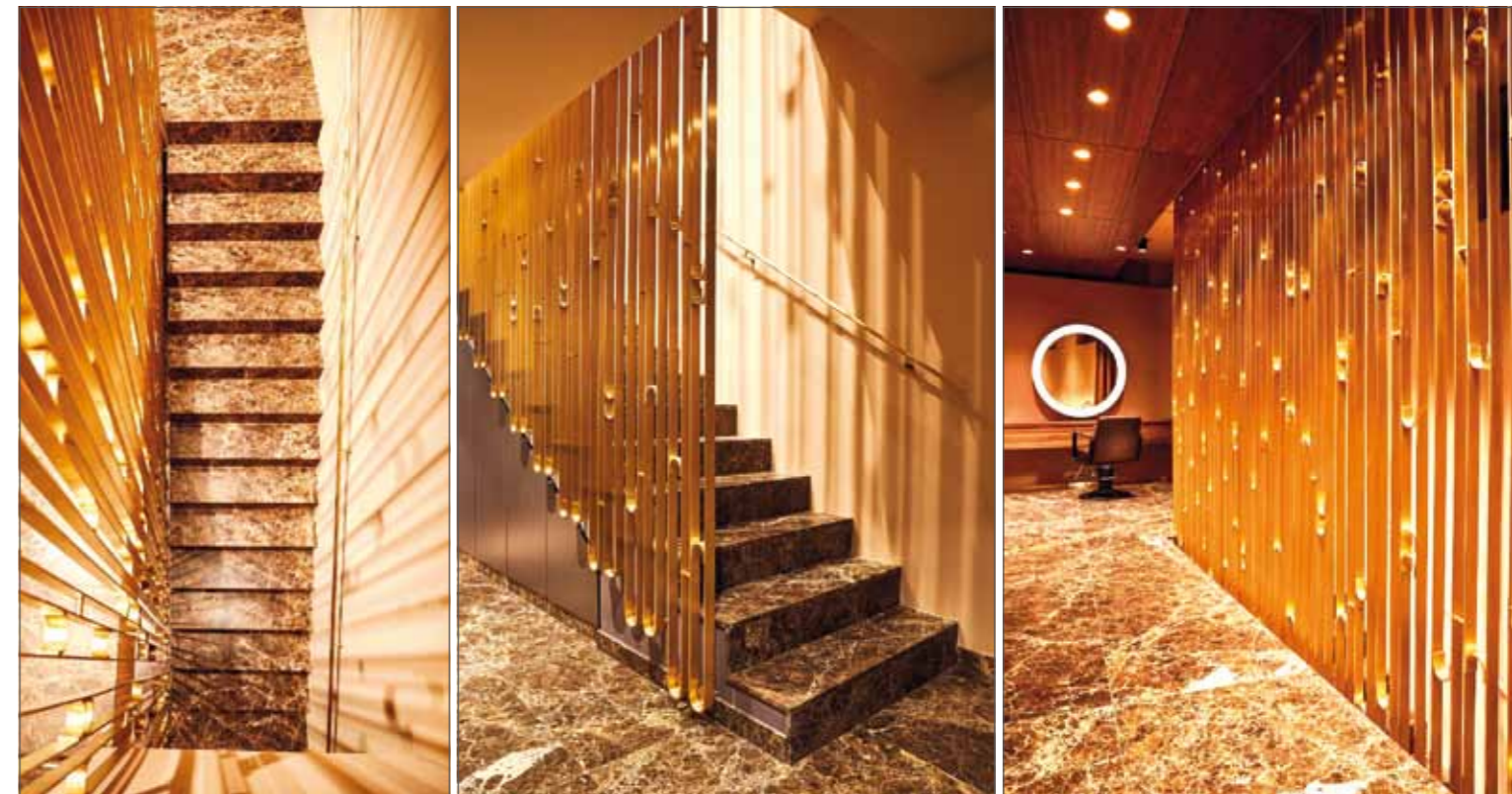
Der Naturstein gibt fast überall den Ton an. Und er vergoldet sozusagen das gesamte Ambiente des Pony Clubs. Neben den Bodenbelägen wurden mit dem Marmor „Emperador Gold“ auch der Bartresen, die Toilettenanlagen und die Treppe ausgestattet.
